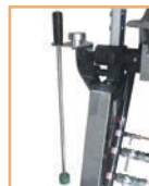
釜の左で保管する排水栓抜き棒
